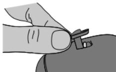
5. Introduire le tournevis dans l'ouverture située au-dessus du compartiment pile
