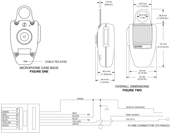
**RJ11 CONNECTOR (TO MICROPHONE)**
